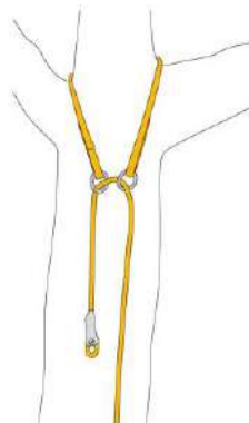
Fig. 8 - Ancoraggio passante per corda raddoppiata
