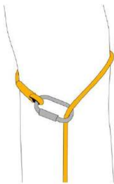
Fig. 2 - Strozzo diretto della funne
